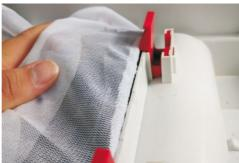
6.5 Schütten Sie die Trümmer im Beutel aus. Verwenden Sie einen Schlauch, um Wasser zu sprühen und den Beutel zu reinigen.
