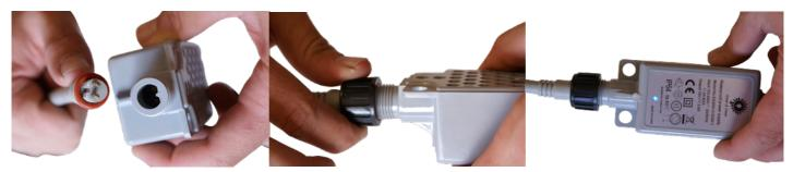
4.3 Stecken Sie das Ende des schwimmenden Kabels am Stromnetz an. Achten Sie auf die Ausrichtung von Stecker und Buchse.
