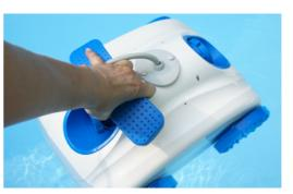
4.2 Legen Sie den Roboter in den Pool und warten Sie, bis dieser vollständig eingetaucht ist. Bei Bedarf helfen Sie beim versenken manuell nach.
