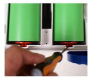
8.2: Wenn Fremdkörper nicht leicht zugänglich sind, verwenden Sie einen flachen Schraubenzieher, um die Rollen vorübergehend zu entfernen. Drücken Sie die Lasche wie im Bild gezeigt, um die Laufrollen zu entfernen.
