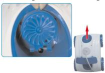
5.1 Um die Richtung des Roboters zu beeinflussen, drehen Sie das Ventil. Die Richtung des Roboters wird durch die Position des Anzeigers bestimmt.
