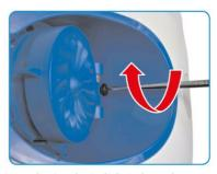
5.2 Um die Geschwindigkeit des Roboters zu beeinflussen, verwenden Sie einen Schraubenzieher um die Schraube an der Unterseite des Deckels zu drehen. Herausschrauben erhöht die Geschwindigkeit und Einschrauben verringert die Geschwindigkeit.
